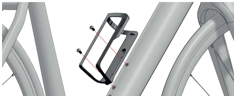
Figura 3-12 BIKEDRIVE AIR | Montaggio del supporto Range Extender
